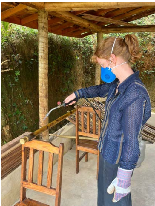
Bambus erhitzen für Baumaterial.
